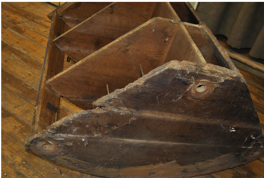
alumina kapp, millelt on eemaldatud tsinkpleki tükid ja külje laud
