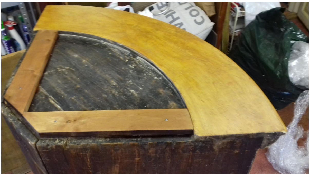
alumise kapi esiserv enne ja peale toneerimist, lisatud ülemise kapi toetusliistud
